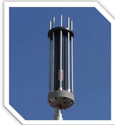
Antenna omnidirezionale per la banda VHF DAB 174÷ 240 Mhz. Studiata per impieghi fissi e mobili. Costruita di serie con copertura in cloruro di polivinile contro urti ed agenti atmosferici. Tutti gli elementi radianti, sono elettricamente collegati a massa. Per facilitare il trasporto, gli elementi sono ad innesto rapido (AR0313IRXZDAB) o svitabili (AR0313XZDAB). Di serie viene fornito il giunto di fissaggio Ø 30 mm. tra l'antenna ed il palo di sostegno.
